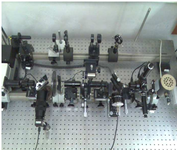
Obr. 9 Fotografie mikro-spektroskopické aparatury postavené ve FZU AVČR, v.v.i. (bez postranních černých stěn)
