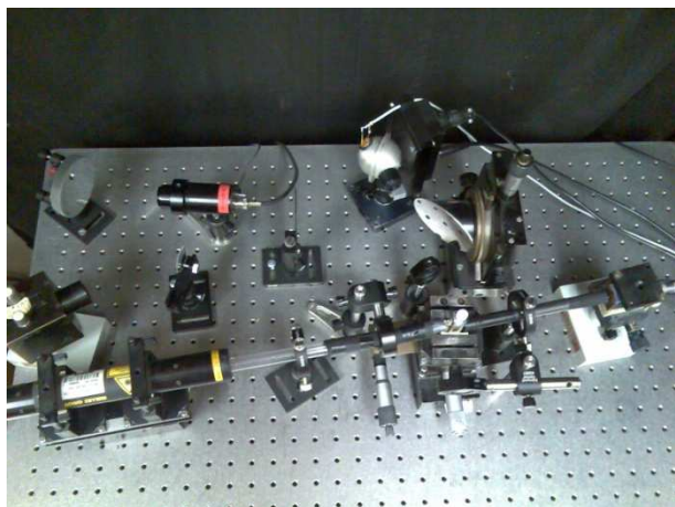
Obr. 4. Fotografie aparatury PDS postavené ve FZU AV ČR, v.v.i. (pouze optické prvky 8 – 12 na Obr. 3) na antivibračním stole).
